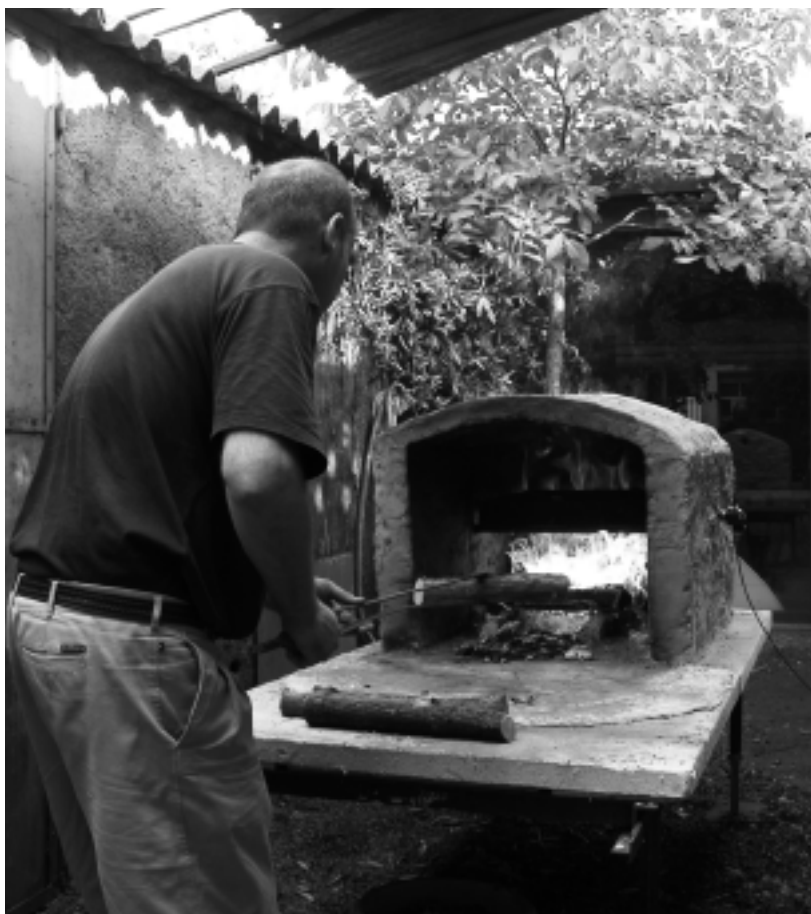
Fig. 4 Expérimentation de la cuisson des verres peints dans un four construit selon le traité d'Antoine de Pise.
