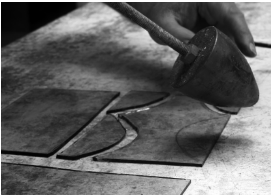
Fig. 2 Expérimentation de la coupe au fer chaud.
